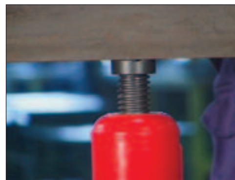
▲ Ходовой винт (screw spindle)
