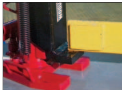
▲ ДА10П150К в работе низким подхватом (in use with claw)
