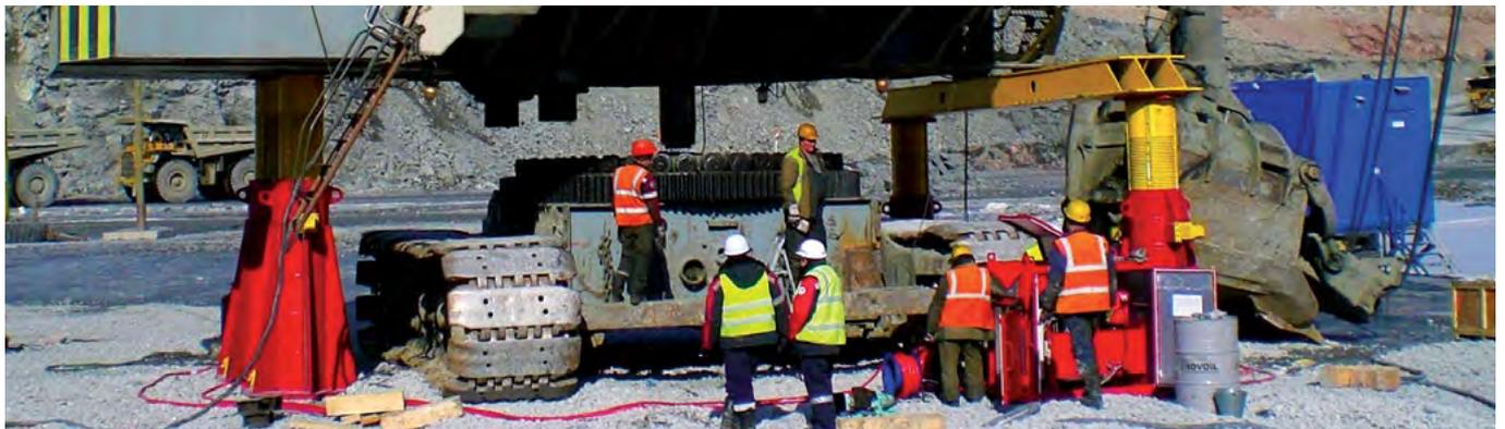
■ Комплекс гидравлический КГПЭ4-100 предназначен для подъема, удержания и опускания тяжелых объектов, например, поворотной платформы карьерного экскаватора при проведении плановых и экстренных ремонтов в полевых условиях, на месте производства горных работ.
