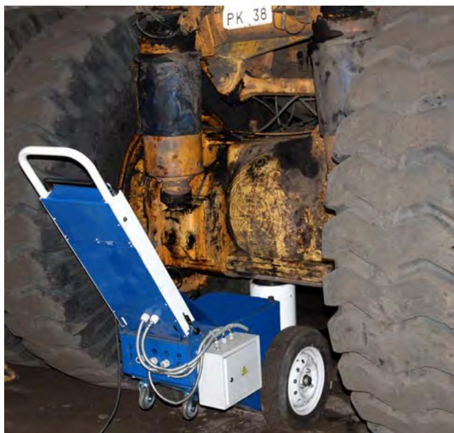
для поддержания передней (задней) оси карьерной техники в вывешенном состоянии в зоне технического обслуживания при снятии колес.
