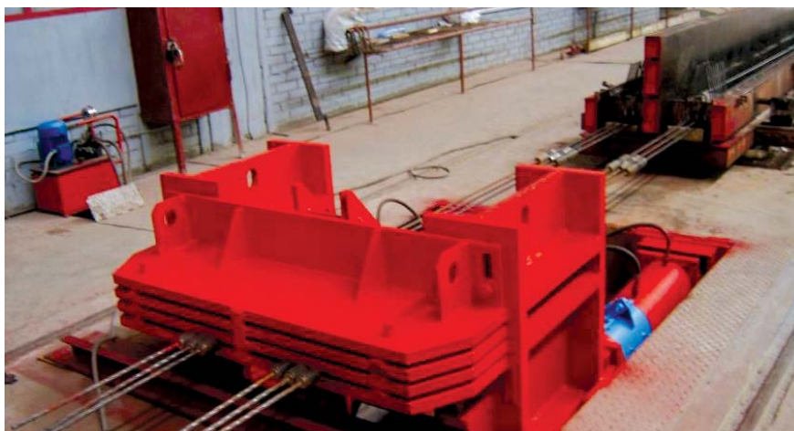
Стенд производства преднапряжённых Ж/Б конструкций
