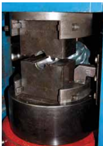
Монтаж матриц в пресс ППК-С400МА
