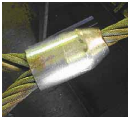
Втулка, опрессованная в наружной полости матриц
