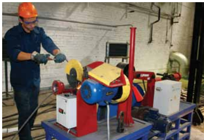
Перемотка и мерная резка каната на установке УРКС-65 «Энерпром» в цехе по производству стальных канатных стропов ОАО «Белорецкий металлургический комбинат»
