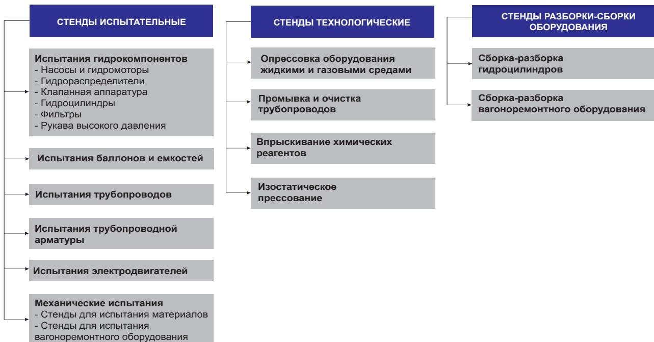
«Энерпром» специализируется на разработке и производстве стендов различного назначения, которые классифицируются тремя крупными группами: испытательные, технологические, стены для разборки-сборки различного оборудования. Разработана широкая гамма испытательных стендов в соответствии с функциональными методами тестирования изделий.
