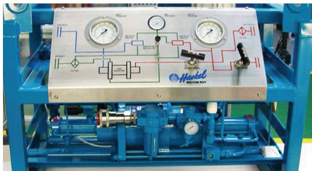
Одноступенчатые компрессоры прямого действия модели **AG** являются экономичным вариантом при создании давления для испытаний небольших компонентов с малыми рабочими объёмами, когда величина КПД не является важным параметром. Контроль максимально-го давления осуществляется регулятором, приводимым давлением сжатого воздуха.
