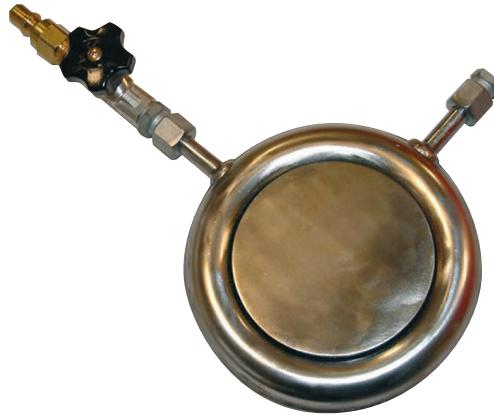
■ Соотношение высоты домкрата и его диаметра составляет 1/9, поэтому можно применять при подъеме объекта, в условиях, когда горизонтальная составляющая силы от веса объекта велика. В такой ситуации опасно применение обычных поршневых или винтовых домкратов, не рассчитанных на воздействие опрокидывающего момента от горизонтальной составляющей силы.
