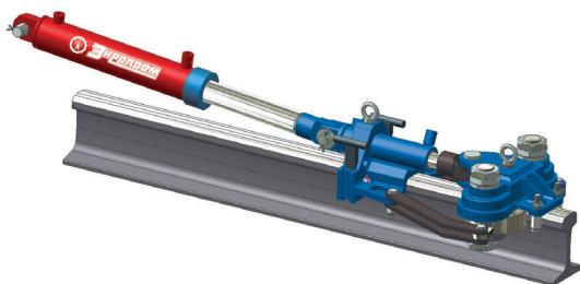
■ Система включает два энцентриковых толкателя, специальную 2-х-портовую насосную станцию, рукава высокого давления с быстроразъемными соединениями. Применяется на рельсах типа Р65. Основные составные части толкателя: силовой гидроцилиндр с гидравлическим возвратом поршня; энцентриковый зацеп упора с клиновой вставкой; гидроцилиндр управления зацепом; съемный башмак на кронштейне на донышке силового гидроцилиндра.
