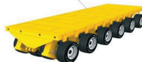
Модульный транспортер 200 тонн
