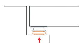
Испытание мостовых опор
