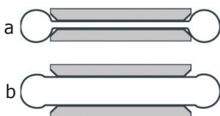
Сечение стального плоского домкрата: а - в исходном состоянии; b - в раздутном состоянии.
