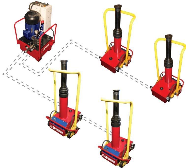
■ Предназначен для подъема, выравнивания, фиксации и опускания крупных, многотоннажных объектов в N точках с боковым подхватом объекта; применяется при наличии жесткого основания под домкратными модулями. Разработана и изготовлена система СМП-200, грузоподъемность 50x4=200 тс, допуск по отклонению объекта ±1мм.
