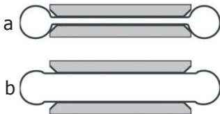
Сечение стального плоского домкрата: а - в исходном состоянии; б - в раздутом состоянии.
