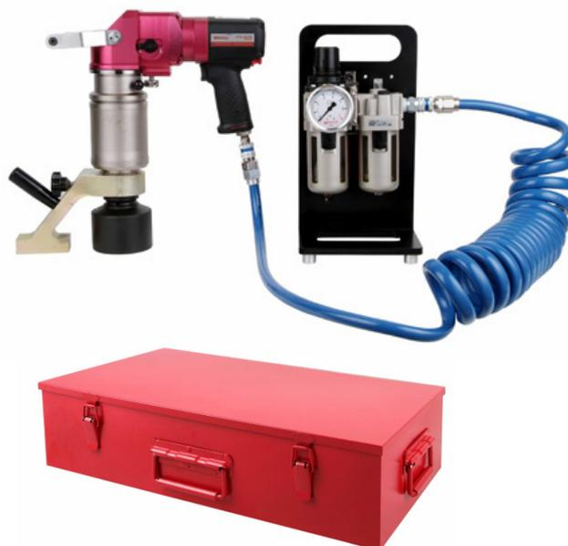
\*Частота вращения без нагрузки при давлении воздуха 6 бар, переключатель скорости в положении 2-высокая.
