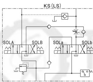
Электромагнитный распределительный клапан.
