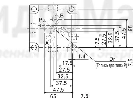
Примечания: 1. При переключении ручного рычага на подачу, направление потока рабочей жидкости от порта P к A, от порта B к T.
