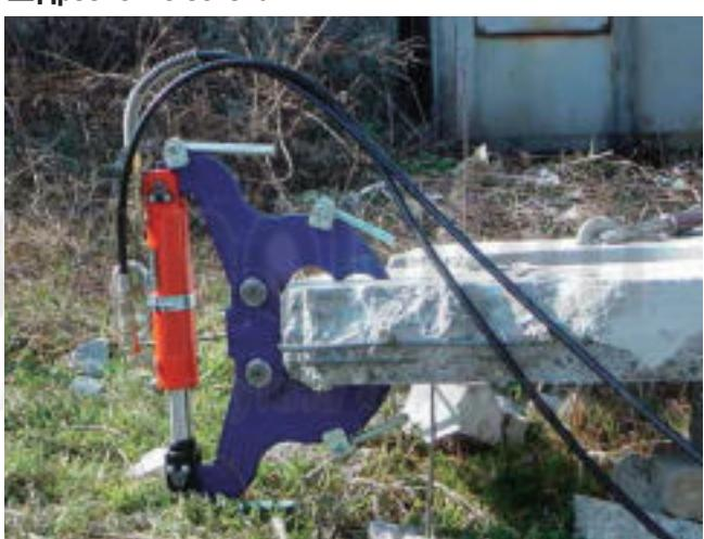
Ручная дробилка (корпус домкрата из сплава титана)
