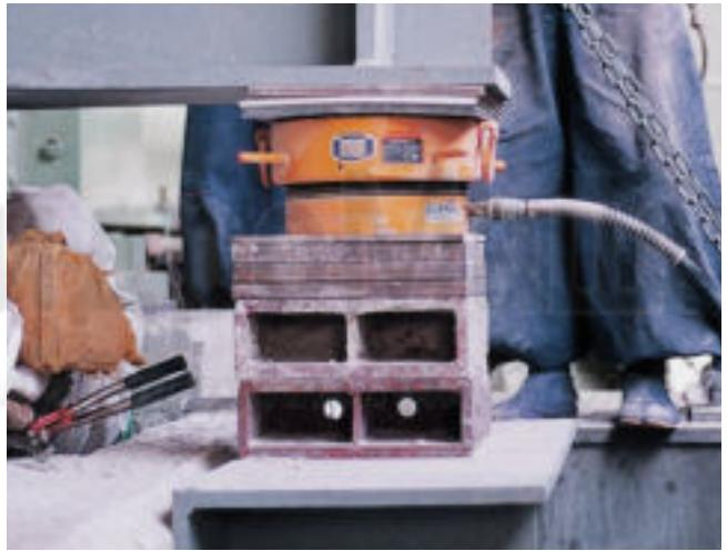
Ручной насос TWA-1.3-PG и низкий домкрат FN200S3 с фиксирующей гайкой
