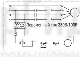
Электрическая схема с понижающим трансформатором
