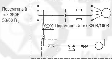
Электрическая схема с понижающим трансформатором
