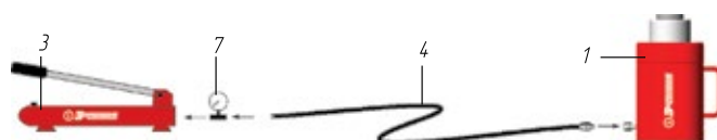
Система с одним рабочим механизмом одностороннего действия
