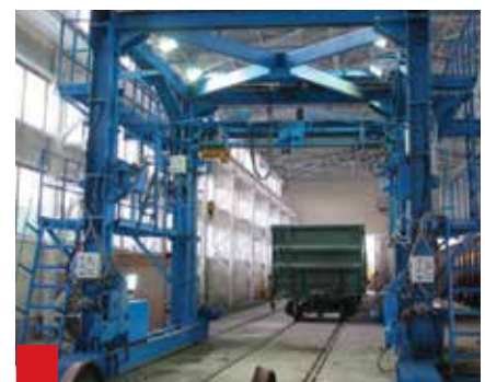
Специализированная вагоноремонтная машина ВРМ «Витязь». Заказчик ОАО «РЖД».
