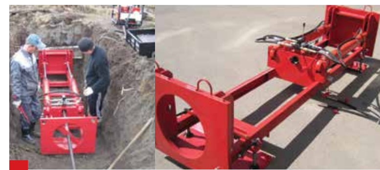
Установка прокола грунта УПГ-25У "Стрела" для бестраншейной прокладки подземных коммуникаций. Производство и поставка предприятиям, специализирующимся на прокладке инженерных коммуникаций.
