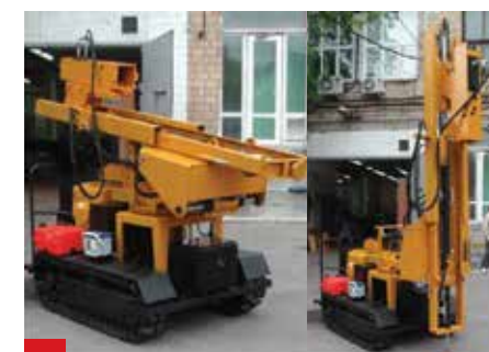
Установка сваебойная малогабаритная МСУ-800, г. Москва.
