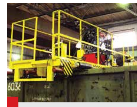
Установка для правки верхней обвязочной рамы полувагонов УП-2М для ОАО «РЖД».
