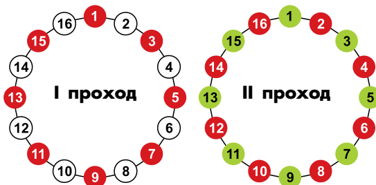
Болтов 16, тензорных домкратов 8 При синхронной затяжке маркируйте тензорные домкраты порядковыми номерами согласно процедуры затяжки!
