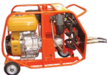
**Насосная станция для гидроинструмента динамического действия** – отбойных молотков, бетоноломов, шлифовальных, отрезных машин, погружных шламовых помп, гайковертов, сварочных аппаратов, силовых генераторов и др. Номинальное давление 12-14 МПа, с мультипликатором давления 70 МПа.
