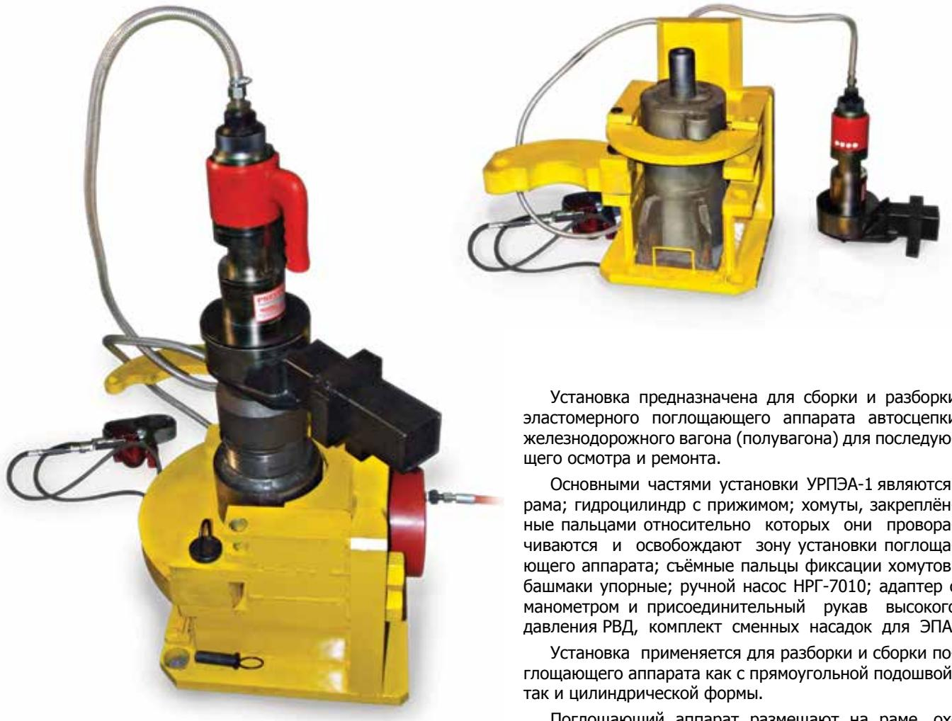
Установка предназначена для сборки и разборки эластомерного поглощающего аппарата автосцепки железнодорожного вагона (полувагона) для последующего осмотра и ремонта.
