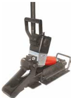
**Рихтовщик гидравлический путевой**, модель РГА10, усилие 11 тс. Предназначен для рихтовки рельсошпальной решетки и стрелочных переводов, уложенных на деревянных и железобетонных шпалах, при ремонте и текущем содержании железнодорожного пути.
