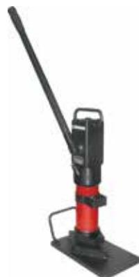
**Домкраты путевые**, модели ДЖА12П160 и ДЖА20П160, усилие 12 и 20 тс соответственно, высота подхвата/подъема 70/160 мм. Обеспечивают безопасное и быстрое поднятие рельсошпальной решетки и стрелочных переводов при среднем и капитальном ремонте, при текущем содержании железнодорожного пути. Оснащен встроенным ручным насосом.
