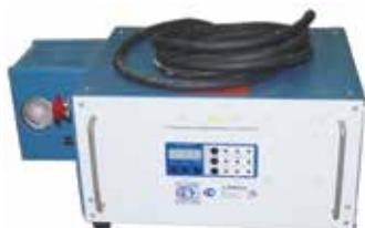
Принцип действия установки основан на индуктировании в металле заклепки вихревых электрических токов под действием высокочастотного переменного электромагнитного поля, в результате чего становится возможным нагрев металла до требуемой температуры. Нагревается одна заготовка.
