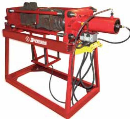
сжимающей пружины. Гидроцилиндр выпрессовщика обеспечивает скатие поглощающего аппарата. Произвести откручивание гайки. Произвести разборку поглощающего аппарата.
