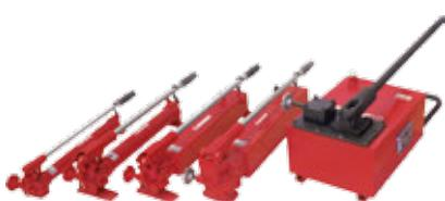
**Насос с ручным приводом.** Надежный источник давления для гидравлического инструмента независимый от внешнего источника питания. Двухступенчатая система подачи масла, автоматическое включение второй ступени, номинальное давление 70 МПа.
