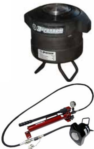
Комплект для снятия поглощающего аппарата КСПА предназначен для демонтажа всех типов пружинно-фрикционных и эластомерных аппаратов (класс от Т0 до Т3), максимальная энергоемкость которых не более 200 кДж.
