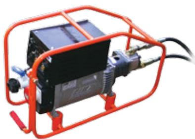
**Аппараты сварочные с гидравлическим приводом** предназначены для выполнения сварочных работ, могут использоваться как силовые генераторы для питания потребителей электрическим током. Сила тока сварочного аппарата 40-300А, диаметр сварочного электрода 4-5 мм.
