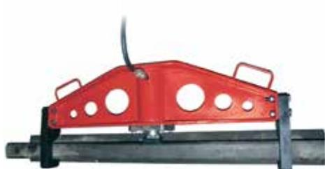
**Рельсогиб гидравлический**, модель РГ3550, усилие 35,2 тс, минимальный радиус гиба 3 м. Предназначен для гиба рельсов непосредственно на месте их укладки по необходимому профилю (на станционных участках, карьерах, горных выработках).
