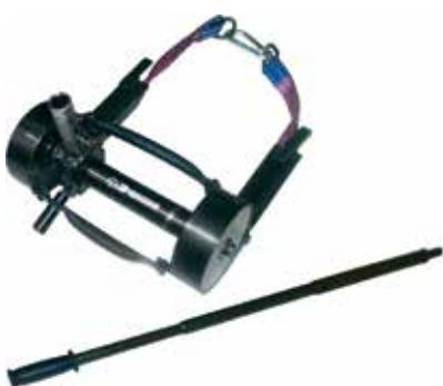
**Лебедка механическая для извлечения и установки шпал**, модель ЛР-1/3Ш, усилие 1 тс, канатоемкость барабана 3 м. Предназначена для извлечения и установки деревянных и железобетонных шпал при проведении ремонтных работ на железнодорожных путях и стрелочных переводах.
