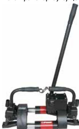
**Разгонщик рельсовых стыковых зазоров**, модель РРА20, усилие 22 тс, величина разгонки 100 мм. Предназначен для продольной сдвигки рельсов или рельсовых плетей для восстановления нормальных зазоров между рельсами, нарушенными в результате угона пути подвижным составом.
