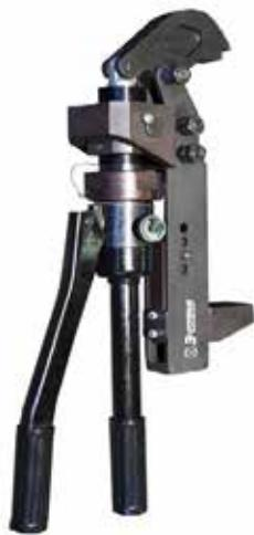
Предназначено для закрытия деформированных крышек люков полувагонов, когда люки деформированы, а также в условиях низких температур при намерзании льда на кромках люков. Оптимальное использование устройства на станциях выгрузки и при подготовке вагонов под погрузку.
