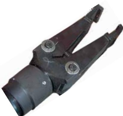
Предназначен для правки поручней и ступеней вагонов при проведении деповского ремонта.
