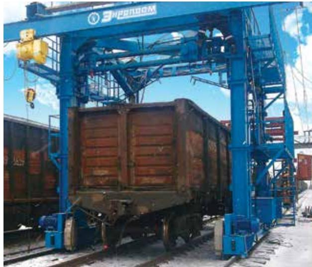
Специализированная вагоноремонтная машина ВРМ-2 предназначена для обслуживания и ремонта грузовых вагонов в условиях ПТО и ППВ, а также при деповском ремонте и позволяет выполнять следующие операции:
