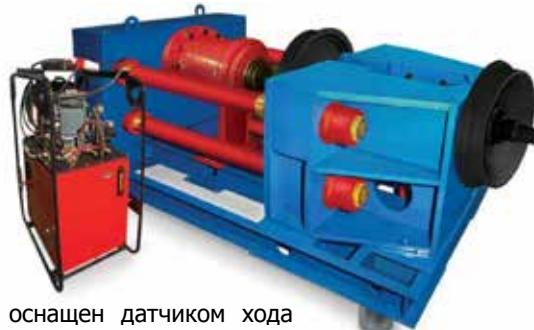
Стенд оснащен датчиком хода гидроцилиндра и реле ограничения хода.
